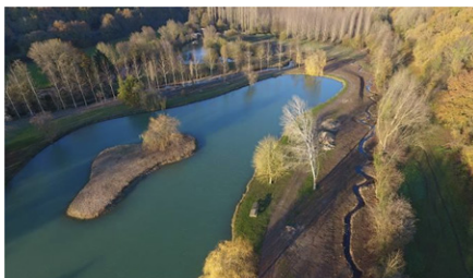
Aménagement de banquettes, reméandrage et remise en fond de talweg (site du plan d'eau communal de la Chapelle-Montreuil 86) - Etat avant et après travaux de restauration avril 2018 - novembre 2018
